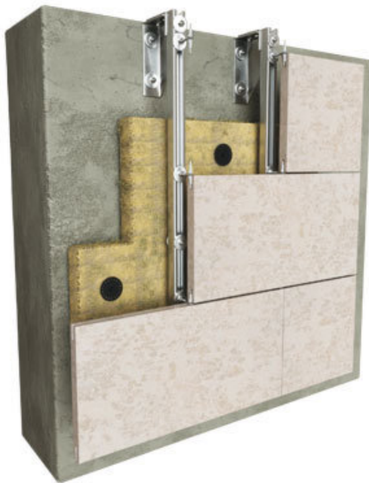
Крепления модульных плит по прямой стене
