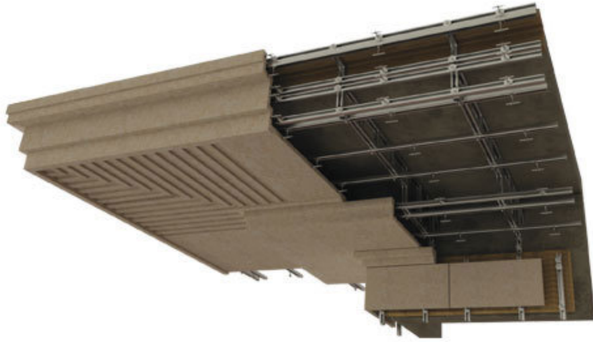
Крепление камня на потолок и подшивка кровли
