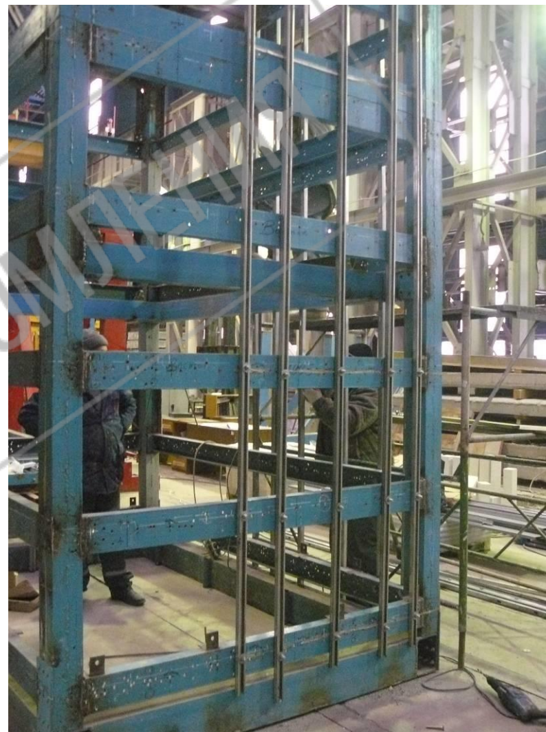
Рис. 4.3. Общий вид станда с установленными на нем направляющими
