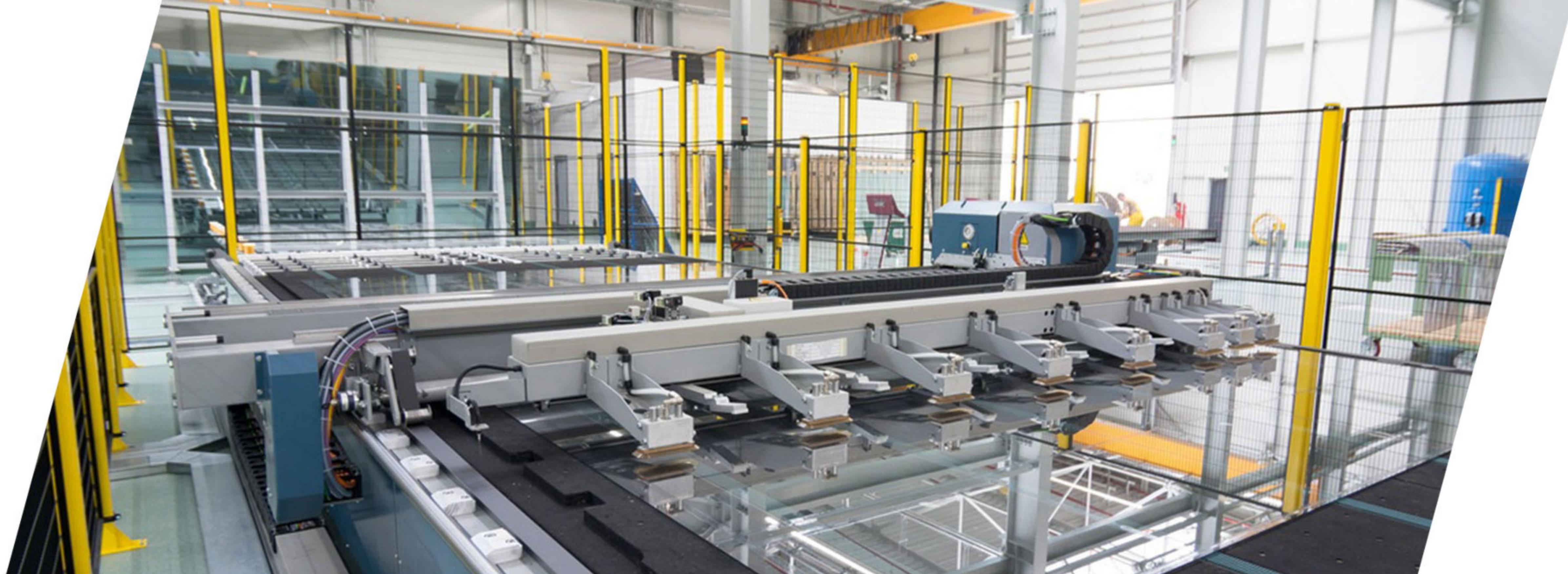
Производственные цеха ISAKIDIS VILMA оснащены новейшими линиями автоматического раскroя стекла джамбо-размера, что дает возможность переработки всех видов плоского стекла толщиной от 3 до 19 мм, а так же раскroя триплекса размером 3210'6000 мм.
