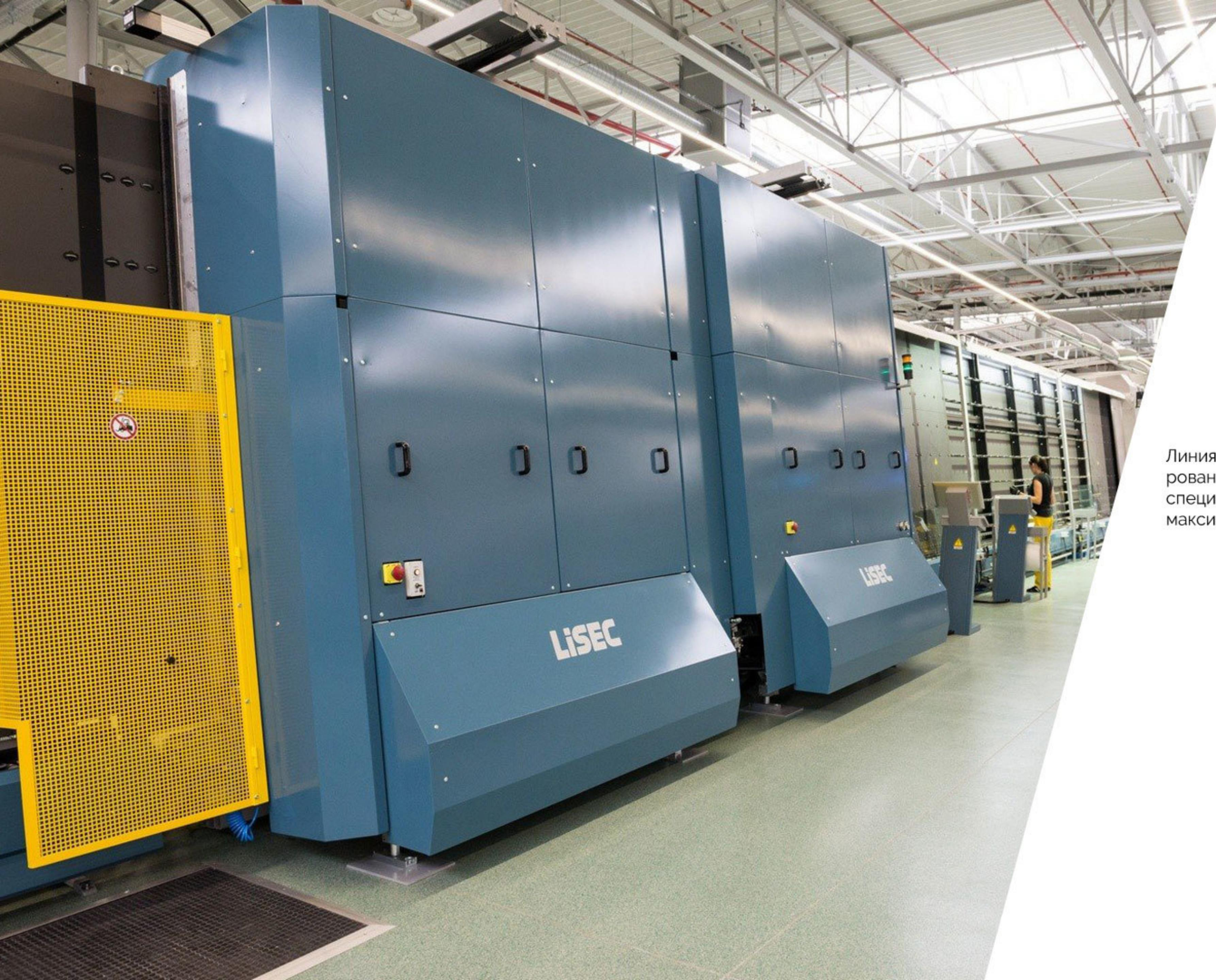
Линия сборки стеклопакетов Liseс позволяет в автоматизированном режиме производить как общестроительные, так и специальные виды стеклопакетов (в том числе структурные) максимальным размером 2500\*5000.
