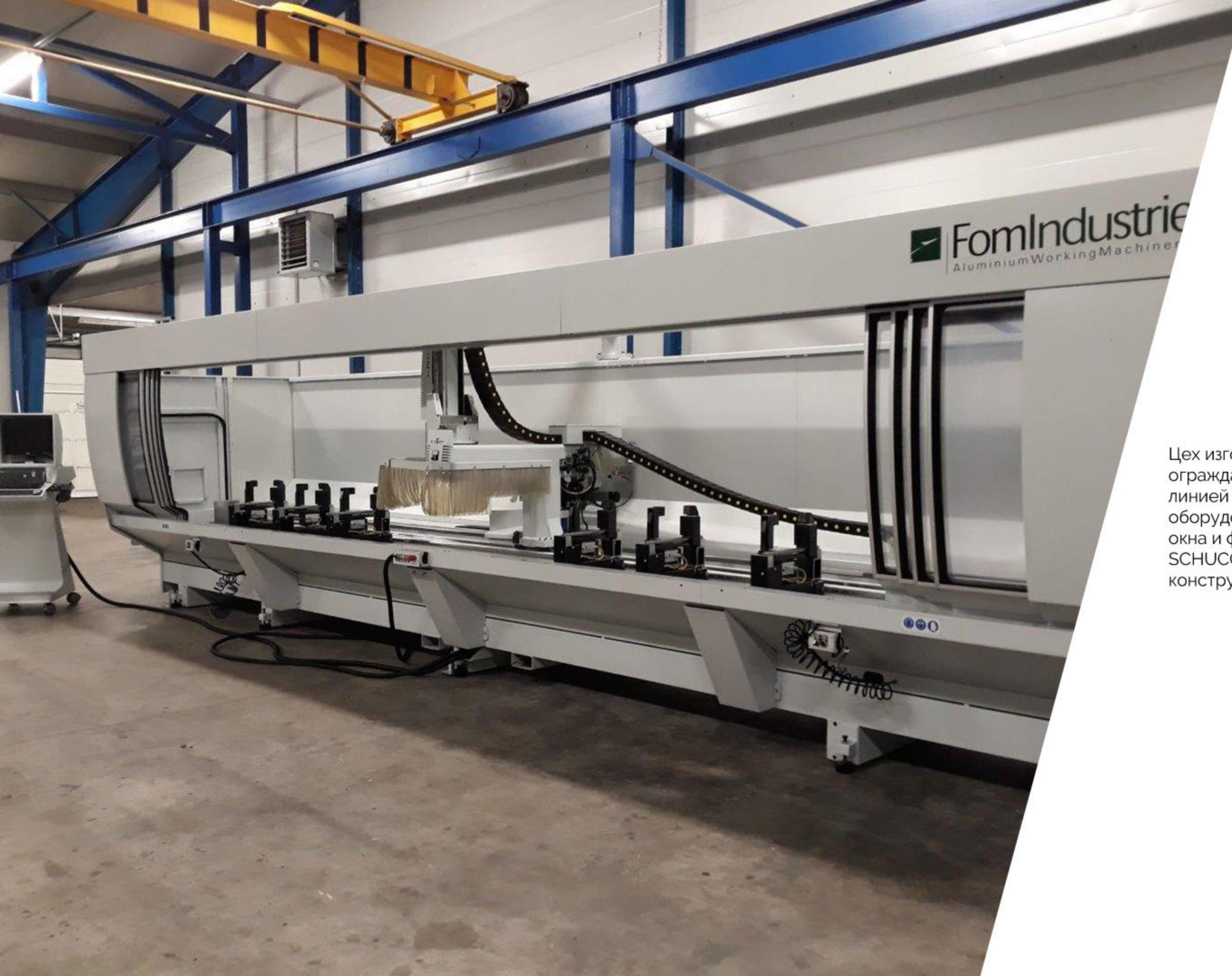
Цех изготовления алюминиевых светопрозрачных ограждающих конструкций укомплектован производственной линией FOM INDUSTRIE с программным управлением. Данное оборудование позволяет производить алюминиевые двери, окна и фасады любой сложности в профильных системах SCHUCO, Alumil, Alutech. Производительность **до 6 000 м<sup>2</sup>** конструкций в месяц.
