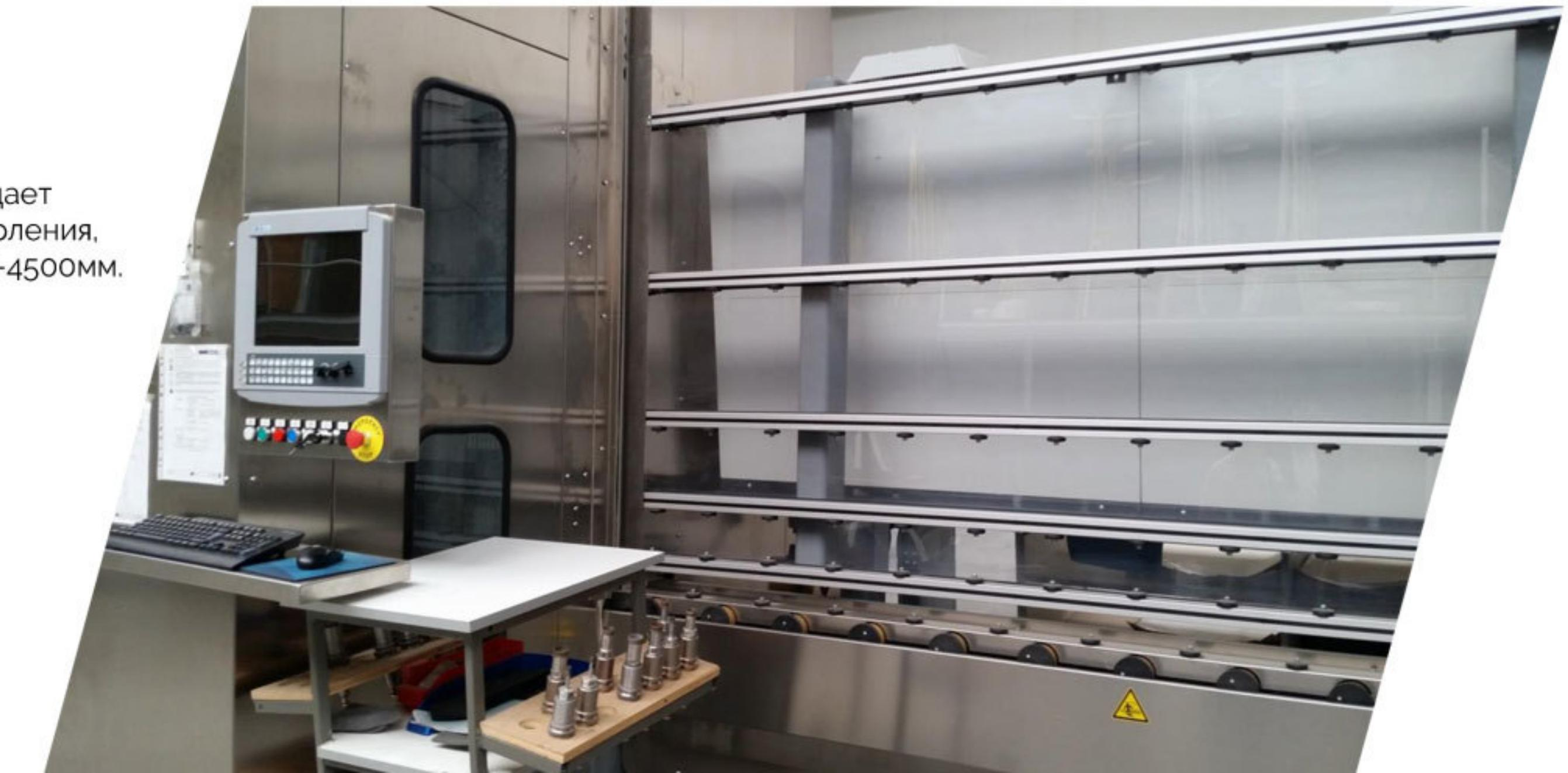
Полуавтоматическая линия полимерной окраски позволяет осуществлять высококачественную полимерную окраску всех видов твердых поверхностей максимальным размером 7200\*1600\*2000 в том числе и окраску алюминиевых системных профилей длиной до 7200 мм.
